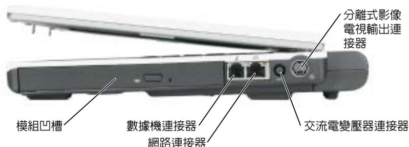
**模組凹槽** — 您可以在模組凹槽中安裝裝置，例如光學磁碟機或 Dell TravelLite™ 模組。若要獲得更多資訊，請參閱第 31 頁的「安裝模組凹槽裝置」。
